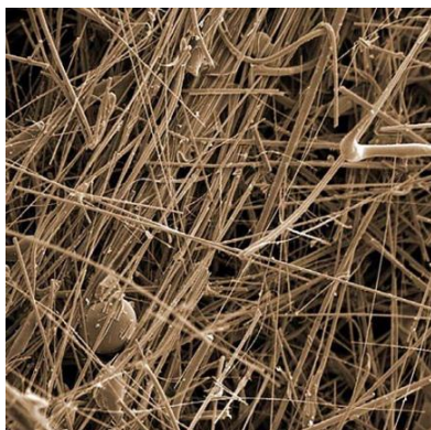
Abb. 3: Steinwolle, Bildbreite 50 µm
