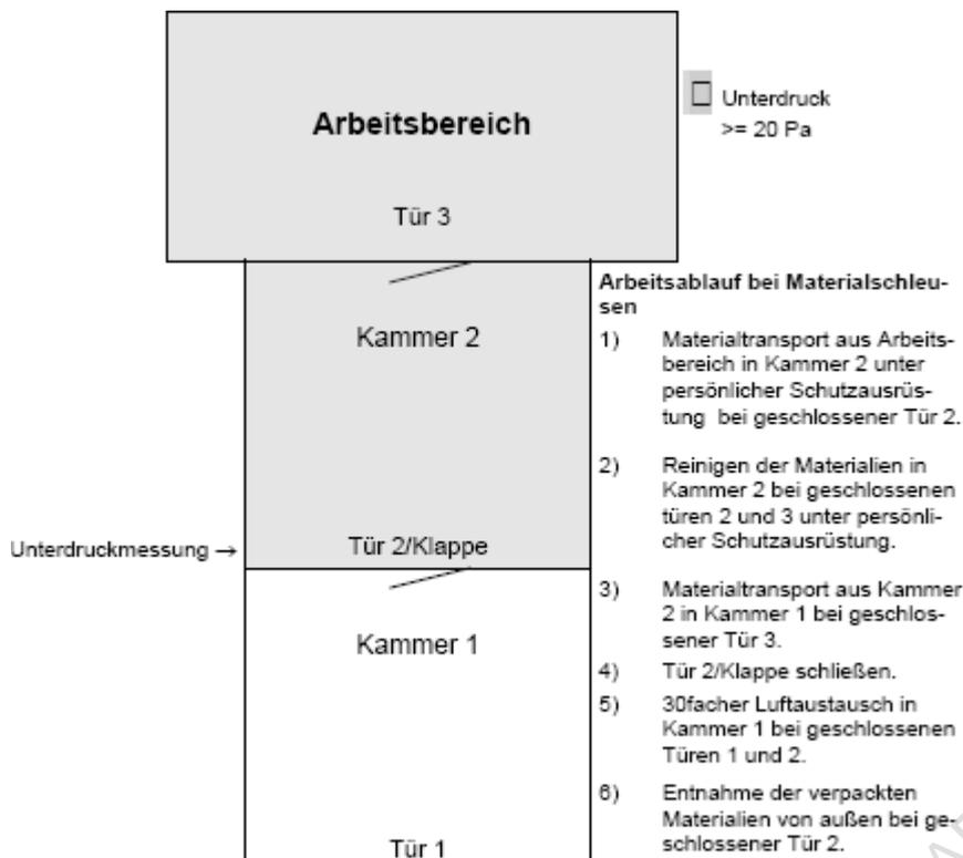
Abb. 2: Materialschleuse (Prinzipskizze)
