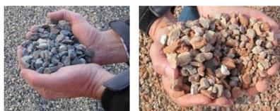
Abb. 31: Typ 1 / Betonsplitt; Typ 2 / Bauwerksplitt [Mettke]
