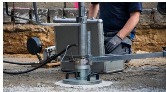
Abb. 21: Prüfung der Frostschutzschicht [SÖR]
