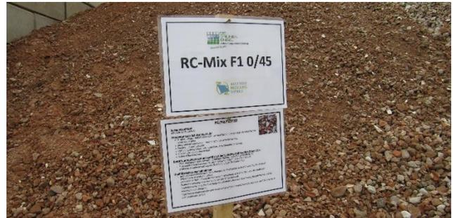
Abb. 2: RC Mix der Fa. DURMIN, gütegesichert und zertifiziert durch Baustoff Recycling Bayern e.V. [Mettke]
