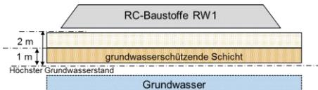
Abb. 29: Eingeschränkter offener Einbau (RW1)<sup>24</sup> [Mettke]
